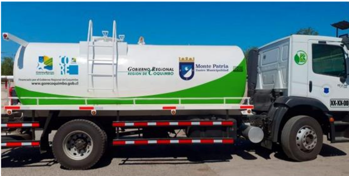
Fotografía 3 Registro recepción Camión Limpia Fosas con Hidrojet
