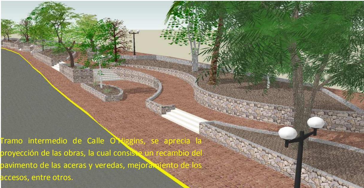
Tramo intermedio de Calle O'Higgins, se aprecia la proyección de las obras, la cual consiste un recambio del pavimento de las aceras y veredas, mejoramiento de los accesos, entre otros.
