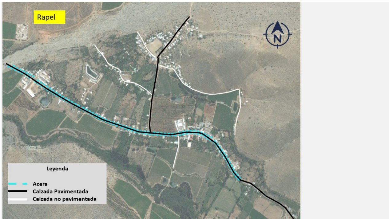
Fig. 33. Materialidad y estado de las vías Localidad de Rapel / Actualización PRC_MPatría
