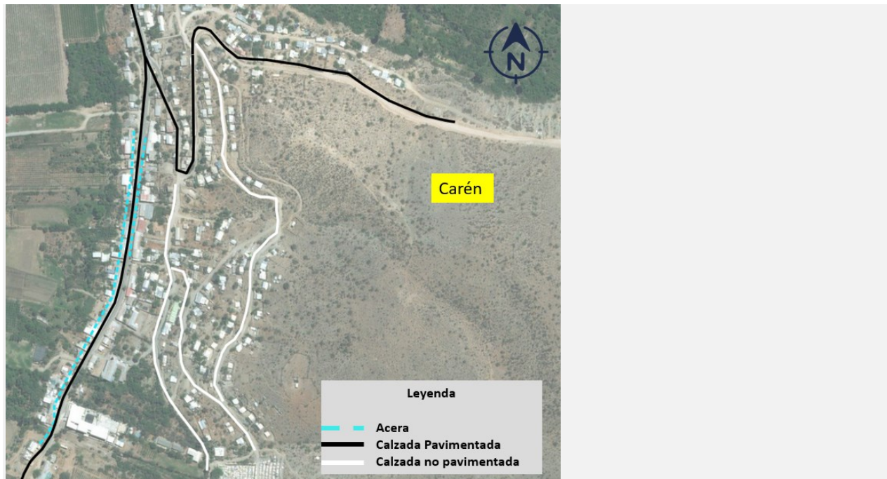
Fig. 29. Materialidad y estado de las vías Localidad de Carén / Actualización PRC_MPatria
